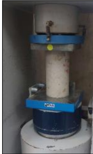
Gambar 3. Pengujian kekuatan tekan beton
