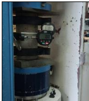
Gambar 4. Pengujian modulus elastisitas beton
