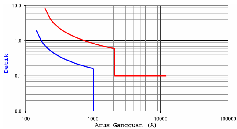
Gambar 24.. Kurva Koordinasi GFR, PBO - PMT
