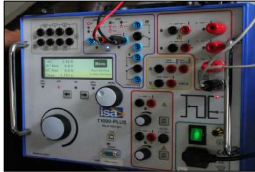
Gambar 17. Alat uji Relay Test Set Sumber : PT. PLN (Persero) Rayon Wonogiri
