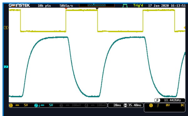
Gambar 19. Kinerja sistem SISO orde-dua tanpa kontroler PID
