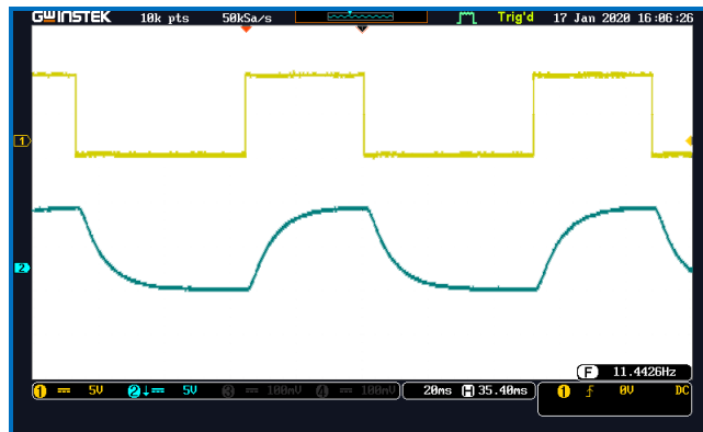
Gambar 22. Kinerja sistem SISO orde-tinggi tanpa kontroler PID
