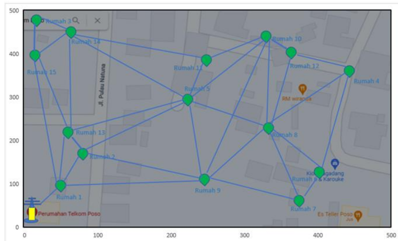
Gambar 7. Banyak rute yang memungkinkan untuk pemasangan serat optis jaringan FTTH
