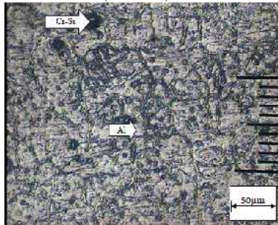
Gambar 3. Foto Struktur Mikro Daerah Las ( weld metal ) 80 A 100 X
