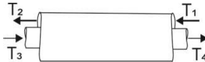
Gambar 2 Skema model aliran di penukar kalor.
