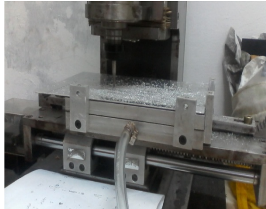
Gambar 3. Proses vacuum clamp pada mesin CNC PC-Based
