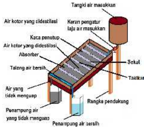
Gambar 2. Model distilasi air absorber kain bersekat penampung air
