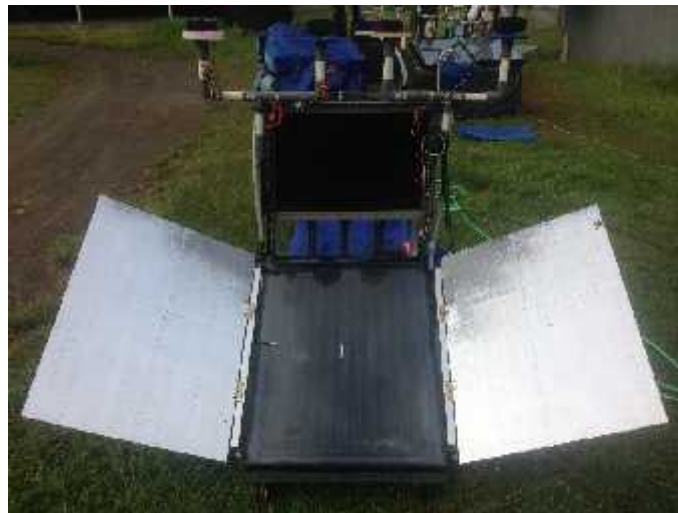
Gambar 2. Alat pemanas air energi surya dengan luasan reflektor penuh sudut 30°
