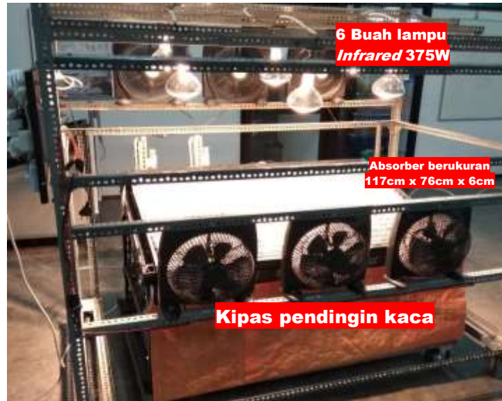
Gambar 1. Model alat destilasi jenis absorber kain bersekat.
