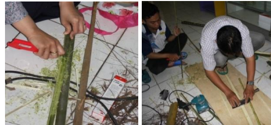
Gambar 4 pembersihan kulit luar dengan dikerik
