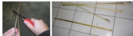
Gambar 5 Pembilahan pelepah kelapa sawit menjadi iratan-iratan
