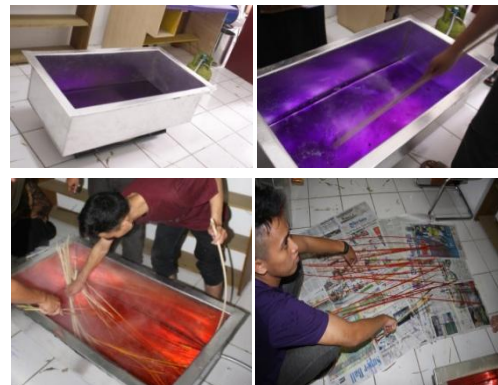
Gambar 6 Pewarnaan dengan cara dicelup
