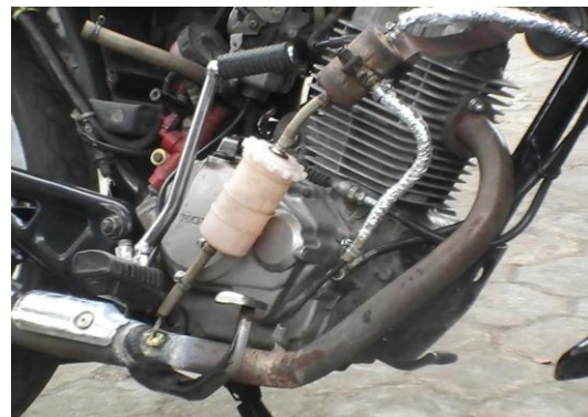
Gambar 1. Instalasi bahan uji sistem penguapan air
