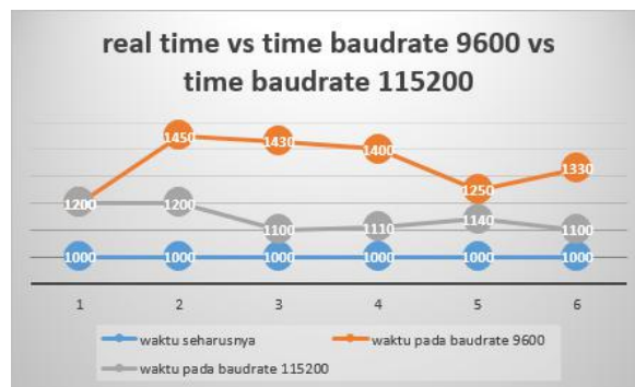
Gambar 9. Grafik perbandingan waktu seharusnya dengan waktu variasi baudrate
