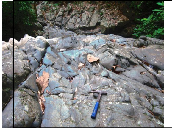
Gambar 2. Kekar-Kekar Pada Batu Andesit Yang Tidak Terisi Urat Kuarsa
