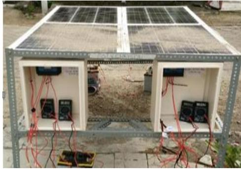
Gambar 4. Pengukuran mono dan poly dengan halangan pasir
