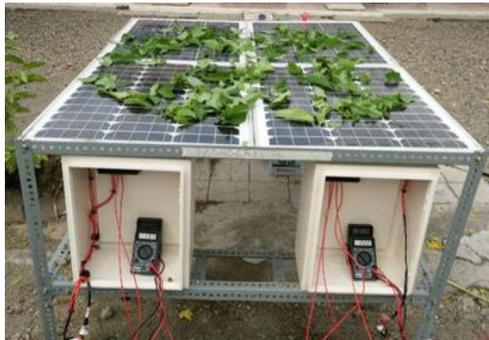
Gambar 5. Pengukuran mono dan poly dengan halangan daun.
