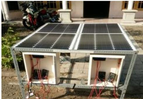
Gambar 2. Pengukuran mono dan poly tanpa halangan.
