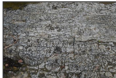
Gambar 2 Singkapan berupa perselingan tufan kasar - sedang dengan batulempung mendominasi disertai kekar kekar intensif
