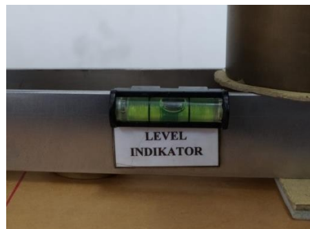
Gambar 6. Lever indikator pada wind tunnel
