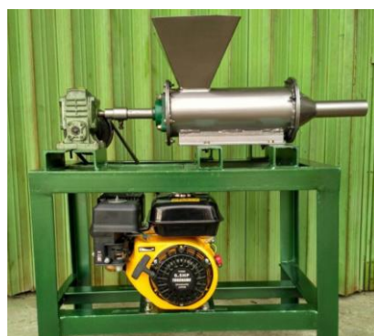
Gambar 2. Mesin cetak sistem screw ekstruder sebagai alat pembuatan briket biomassa berbahan serat TKKS
