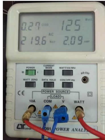
Gambar 10. pengujian alat ukur untuk beban lampu pijar motor induksi 1 phase 300W
