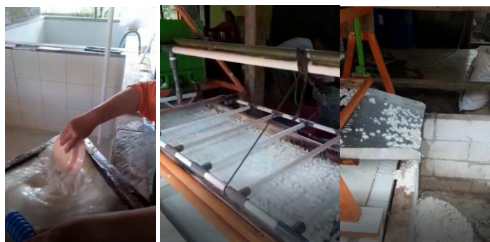
Gambar 6. Proses pengambilan pati singkong dengan proses sinambung.
