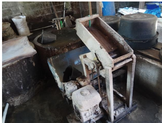
Gambar 2. Mesin parut mekanis sederhana
