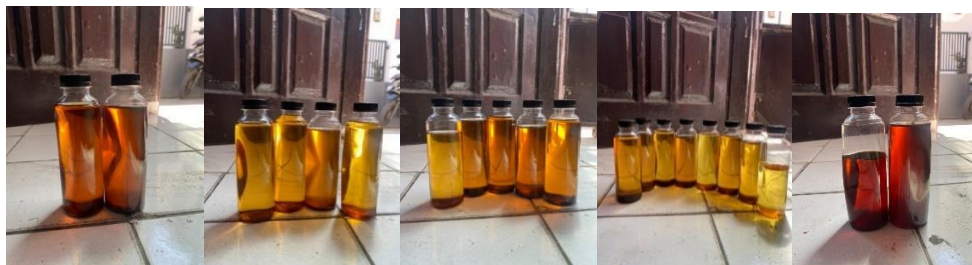
Gambar 9. Hasil distilasi dengan sistem refrigerasi pada suhu 9°C, 3°C, -3°C, -9°C dan tanpa sistem refrigerasi
