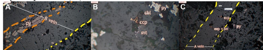
Gambar 6. Gambar sayatan poles lokasi pengamatan 2A. (a) mineralisasi dengan kehadiran “B” vein dengan kehadiran pirit (py) pada bagian tengah vein; (b) kehadiran kalkopirit (ccp), klorit (chl), dan magnetit (mt); (c) hadirnya “A” vein serta keterdapatannya mineral bornit (bn).
