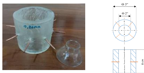
Gambar 3.1. Injektor dengan pipa tembaga \varnothing 0,80 mm
