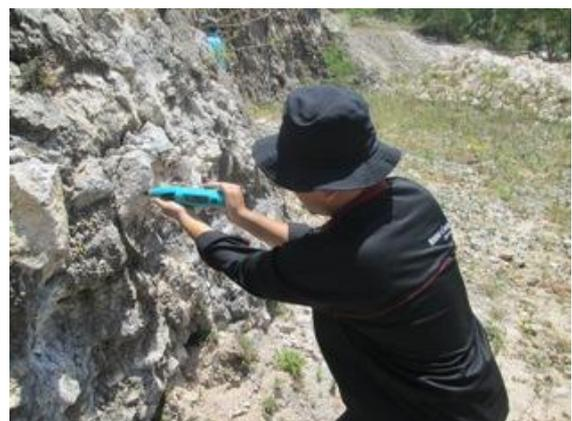
Gambar 5. Pengujian Kekuatan Batugamping di Lapangan dengan Menggunakan Schmidt Hammer
