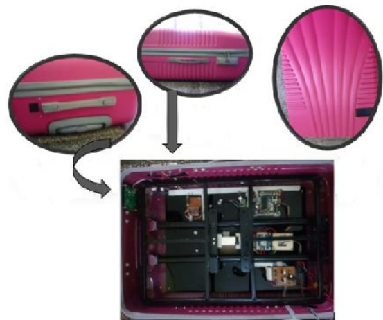
Gambar 3. Instalasi Sistem Pengunci
