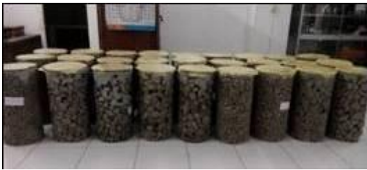
Gambar 8. Benda uji dicapung belerang
