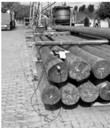
Gambar 3. Pengujian nondestruktif kayu dengan Sylvatest TRIO untuk control kualitas kayu (Benoit dan Sandoz, 2011).
