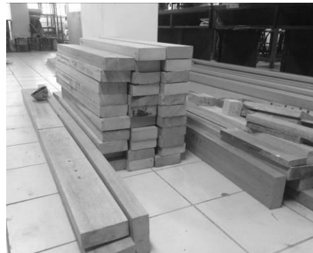
Gambar 4. Benda uji kayu penyusun sambungan join balok-kolom.
