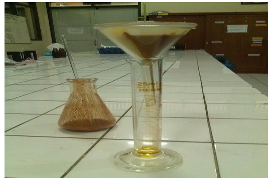
Gambar 4. Minyak nilam yang sudah dimurnikan dengan bentonit.
