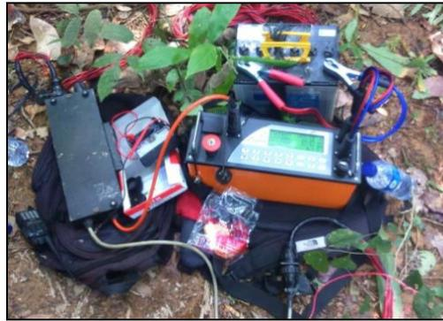
Gambar 2 Peralatan Pengukuran Geolistrik
