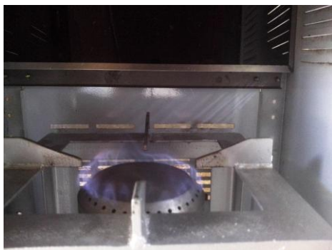
Gambar 16. Foto nyala api burner cup lubang pancar 45^\circ
