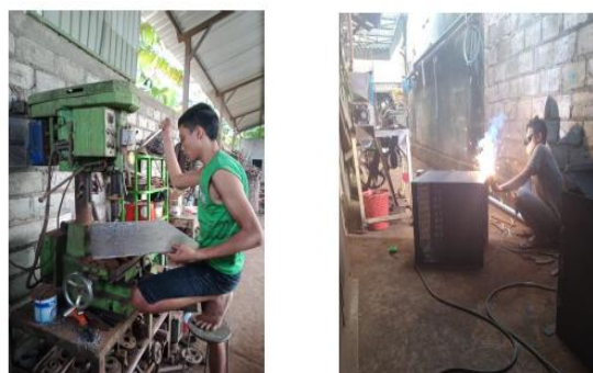
Gambar 3. Proses pembuatan cover ruang bakar bawah
