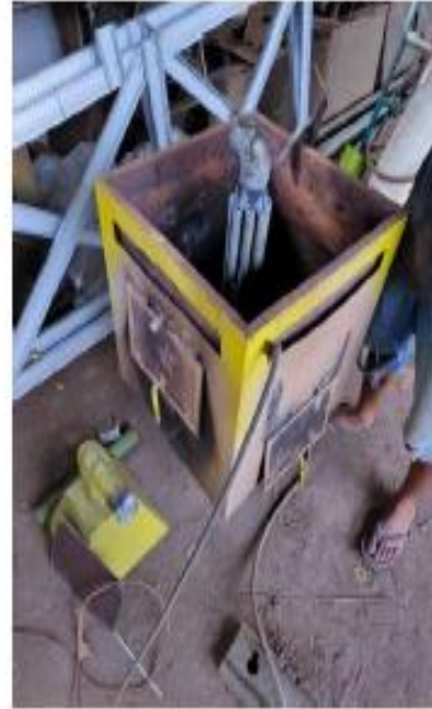
Gambar 10. Proses pembuatan pipa udara sekunder
