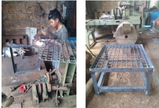
Gambar 1. Proses pembuatan frame bawah dan angasang bawah
