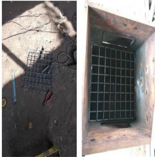
Gambar 4. Proses pembuatan angsang tengah
