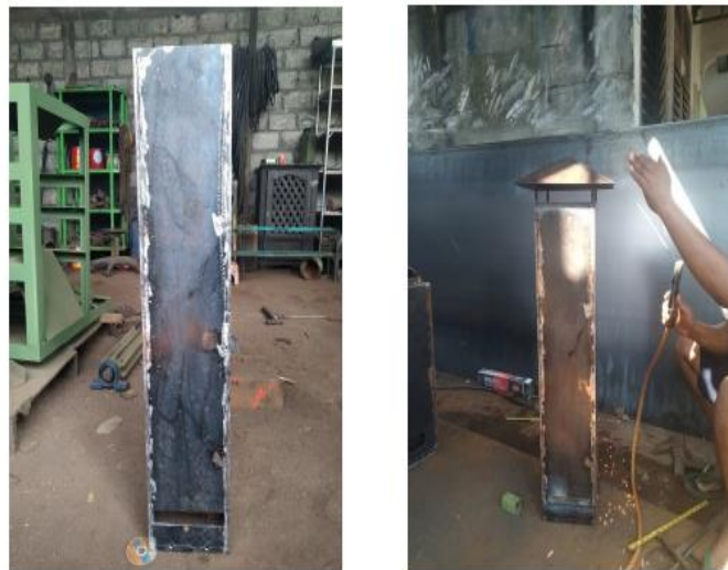
Gambar 7. Proses pembuatan cover ruang bakar atas.
