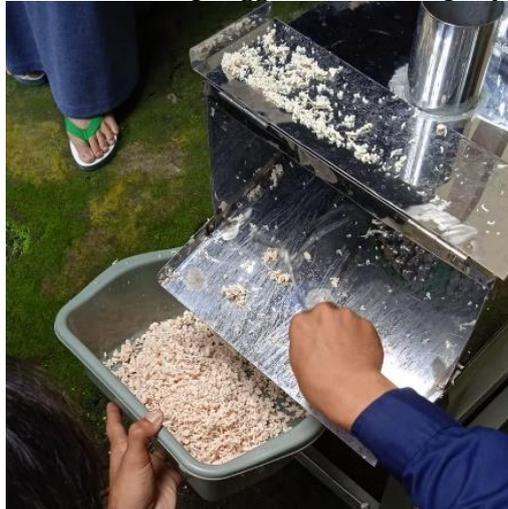
**Gambar 7.** Pengoperasian mesin penyuir daging
