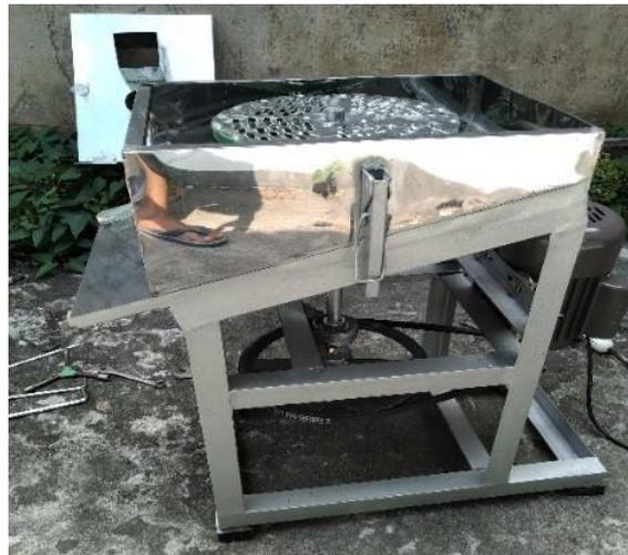
**Gambar 5.** Perakitan mesin penyuir daging
