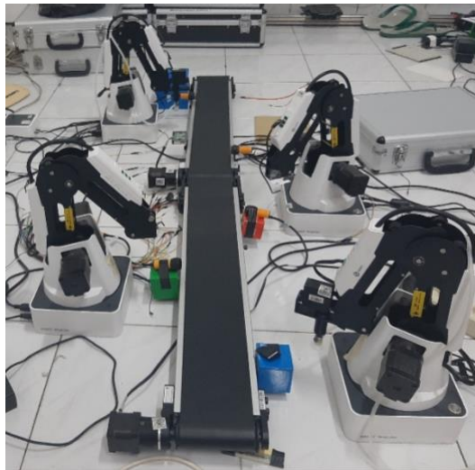
Gambar 2. Pemasangan seluruh komponen pada prototipe robot perakitan
