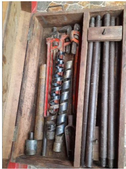
Gambar 1. Auger bor yang dipergunakan untuk mengambil sampel endapan
