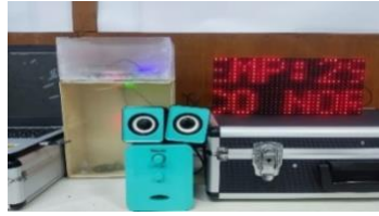
Gambar 5. Bentuk fisik prototipe monitoring dan penetralisir asap rokok berbasis IoT
