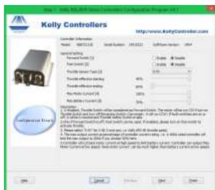
Gambar 5. Pengaturan kontroler dengan KBL user program
