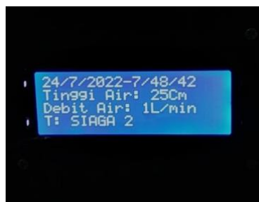
Gambar 7. Hasil pengujian LCD 20x4
