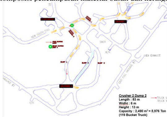
Gambar Sekuen Pengaturan Truck Di Dumping Area
