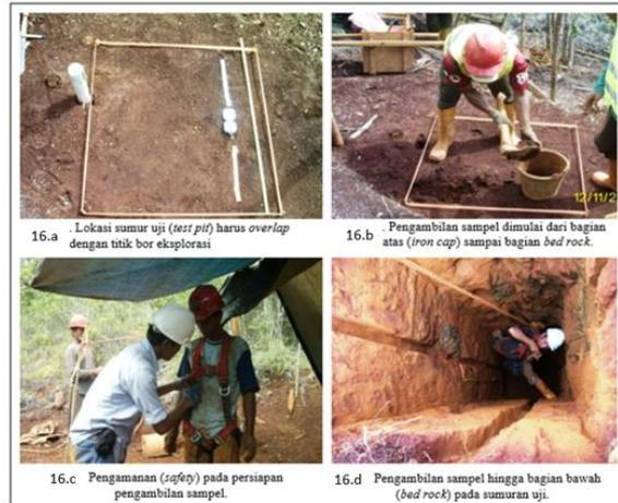
Pada gambar 16.a,b,c,dan d merupakan langkah persiapan pembuatan lobang sumur uji, penggunaan alat safety serta pengambilan material dalam lobang sumur uji.
