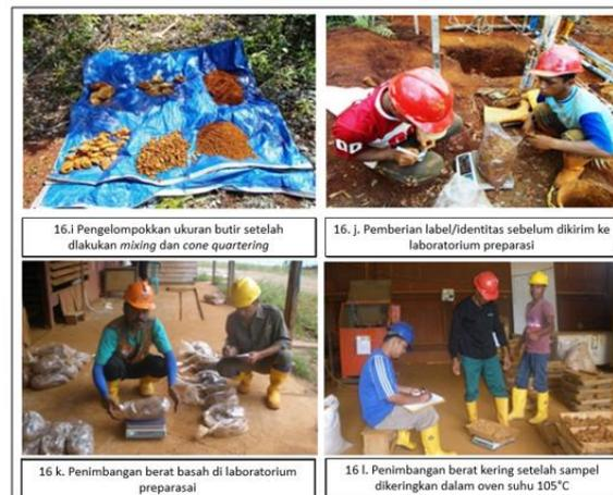
Pada gambar 16. i, j, k, dan l merupakan kegiatan setelah dilakukan pencampuran kemudian dilakukan pemisahan dengan sistem *coning* dan *quartering*, pemberian label pada sampel serta penimbangan berat basah dan berat kering sample di laboratorium preparasi sebelum dilakukan analisa geokimia.
