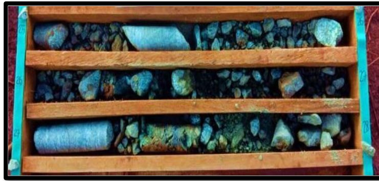
Gambar 7. Kenampakan bedrock dari satuan Olivin websterit dari titik bor
