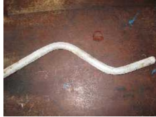
Gambar 3. Uji pengerolan dengan profil S.
