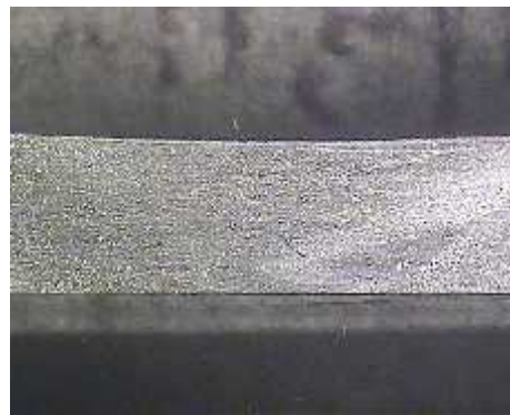
Gambar 7: Struktur makro perbesaran 10x.
