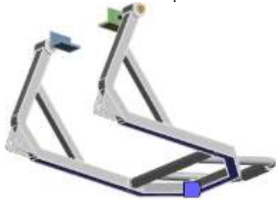
Gambar 2. Fixed support a) variasi desain pertama b) variasi desain kedua
