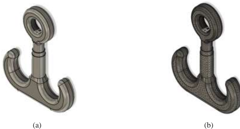
Gambar 1. (a) Desain pemodelan double crane hook , (b) Pembagian domain komputasi
