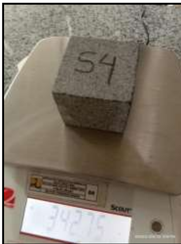
Gambar 3. Penimbangan Sampel Batuan Andesit
