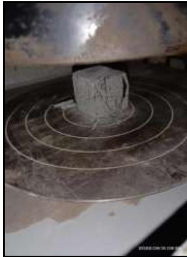
Gambar 5. Pengujian Kuat Tekan Batuan Andesit
