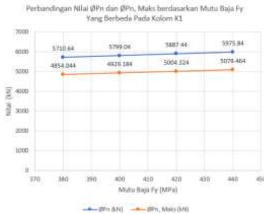
Gambar 4. Hasil Analisis Perbandingan Penggunaan Mutu Baja ( F_y ) Yang Berbeda Pada Kolom K1
