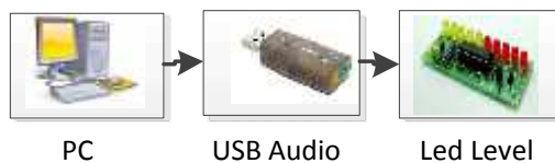
Gambar 1. Diagram blok sistem kendali samar berbasis PC menggunakan port USB.
