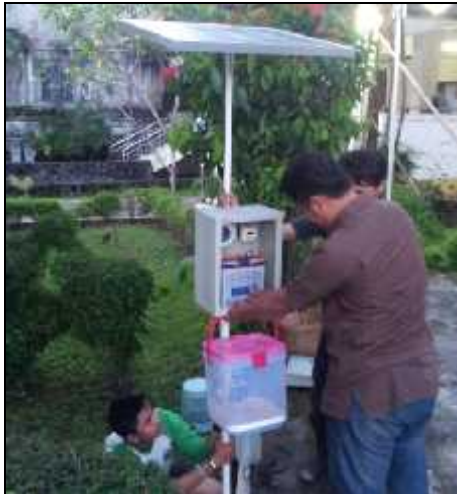
Gambar 5. Hasil Peralatan pakan ayam otomatis
