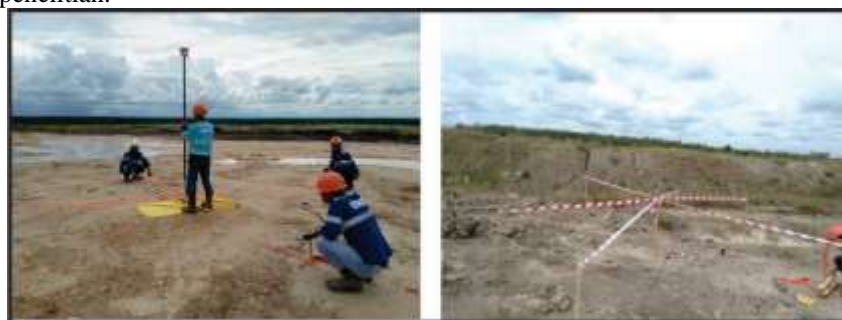
Gambar 2. Pemasangan GCP dan Pengukuran Koordinat
