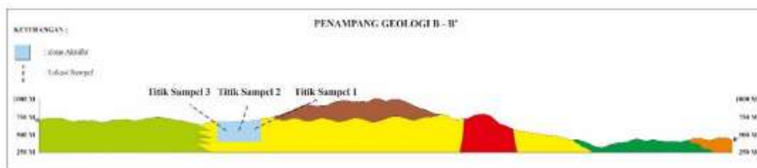
Gambar 11. Interpretasi zona akuifer daerah penelitian berdasarkan titik lokasi pengambilan sampel pada penampang geologi sayatan B-B'.
